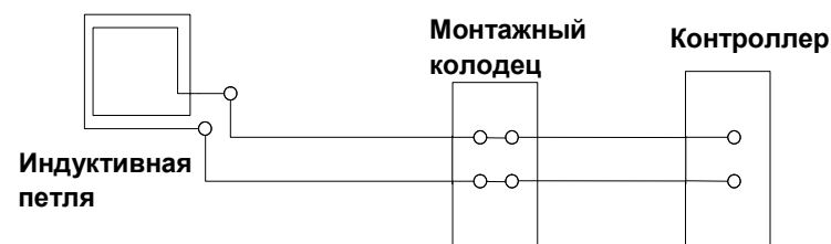
Рис. 5.14. Схема индуктивного датчика
